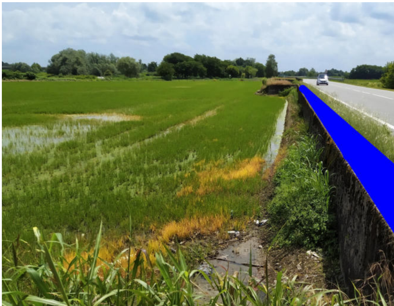
Figura 19. In blu l'alternativa consistente nel sopralzo del muro esistente presso la SP4, analizzata e poi scartata.
