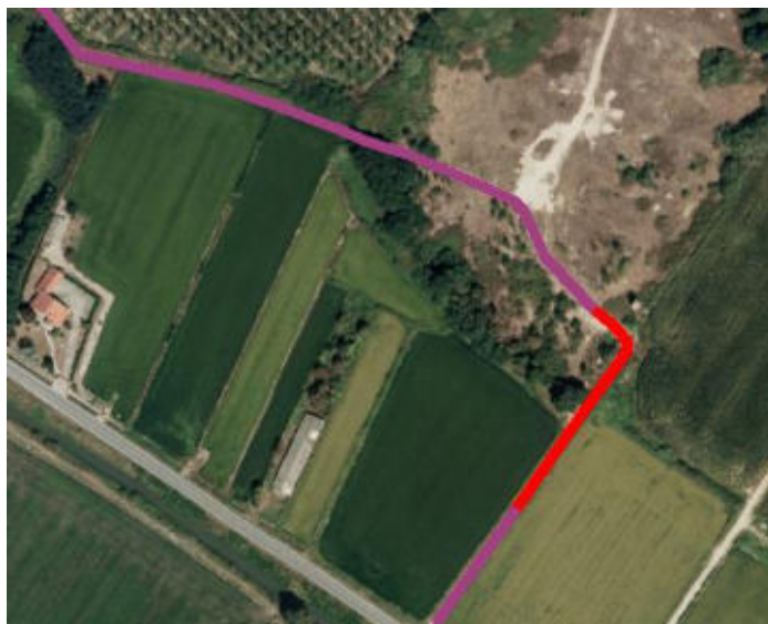
Figura 20. In rosso il tratto di terreno attualmente non in grado di contenere la piena TR 200 anni. In viola i tratti in cui le quote del terreno sono superiori di meno di 1 metro rispetto alla quota di piena TR 200 anni (assenza di franco idraulico adeguato).
